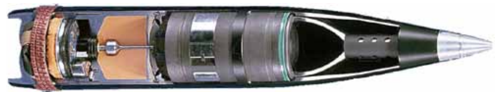
Artilleriegranate 155 mm „Smart“, Schnittzeichnung
